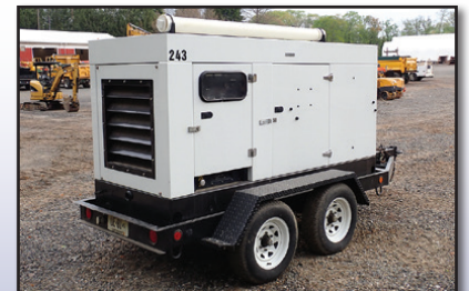
TEREX 72KVA-58KW GENERATOR
